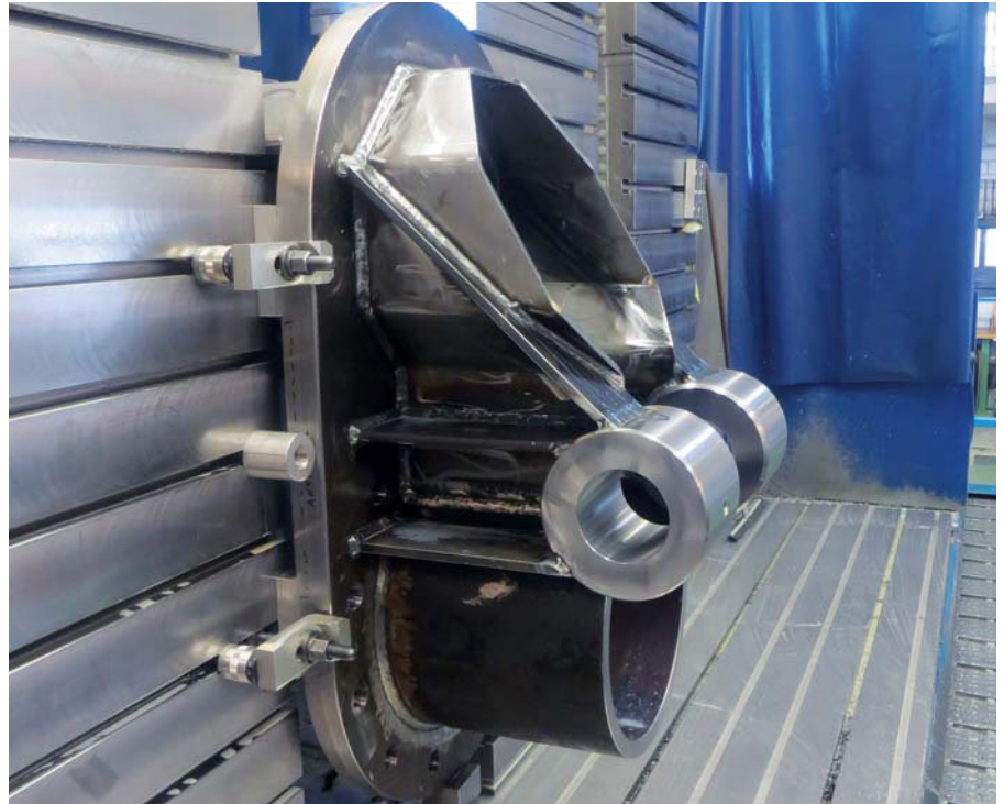
Support de régulation après usinage
