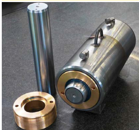
Vérins hydrauliques pour un dessableur
