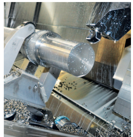
Fräsbearbeitung einer Radsatzachse
