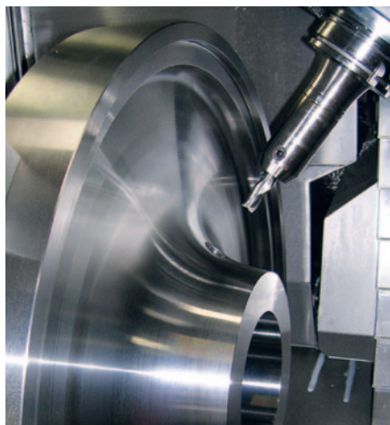
Drehbearbeitung einer Radsatzscheibe
