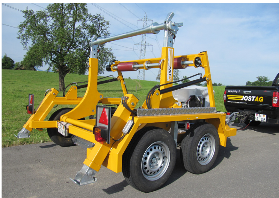
Remorque KSA 3500 à chargement hydraulique de la bobine
