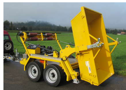
Le système Welaki permet d'utiliser la remorque pour le transport de bennes
