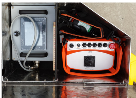
Mesure de la force de traction et télécommande sans fil
