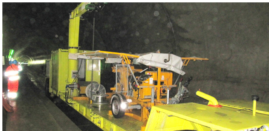
Engin multifonction de la société ABAG, avec treuil à cabestan KZM 4 de Jost AG
