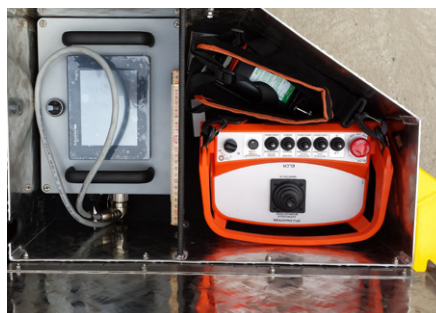
Zugkraftmessung und Funkfernbedienung
