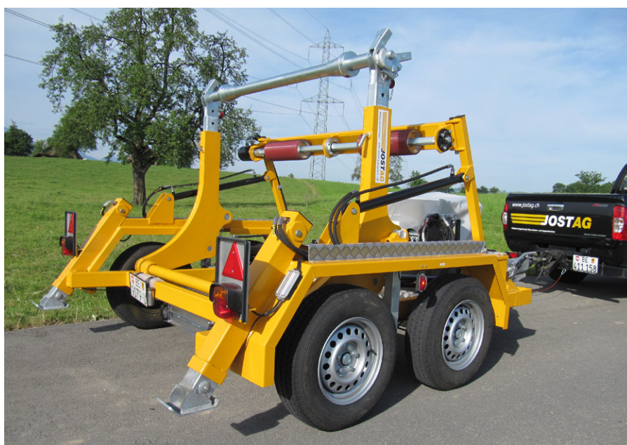
Kabelspulenanhänger KSA 3500 mit hydraulischer Spulenbeladung
