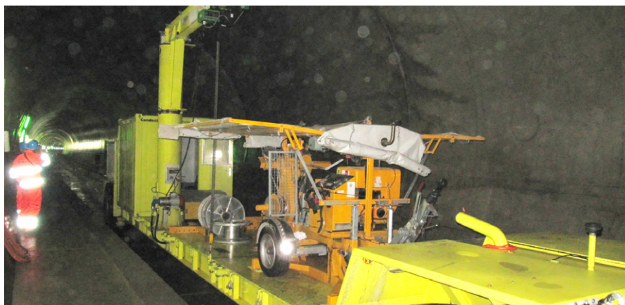
Multifunktionsfahrzeug der ABAG mit der Kabelzugwinde KZM 4
