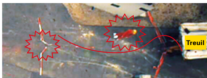
Vitesse avant le bris de la volige : 112 km/h (vue de dessus)
