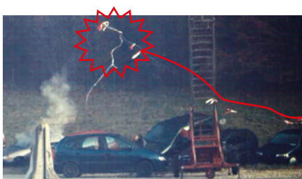
Le câble et l'émerillon sont propulsés en arrière et passent par dessus le treuil à cabestan
