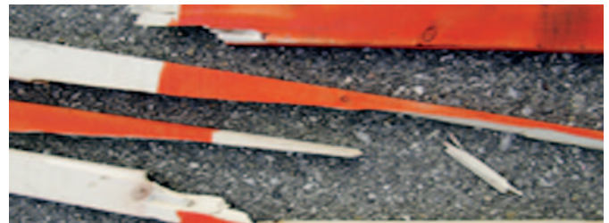
Geschwindigkeit nach dem Bruch der Latte: 105 km/h
