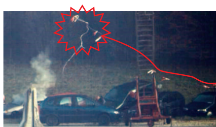
Das Seil mit dem Drallwirbel wird über die Kabelzugmaschine hinweg nach hinten geschleudert
