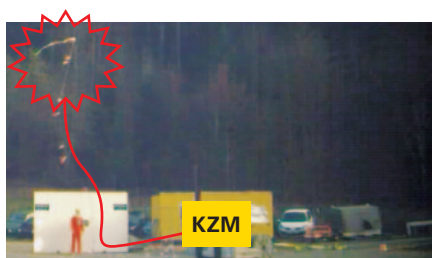
Das Seil mit dem Drallwirbel wird über die Kabelzugmaschine hinweg nach hinten geschleudert
