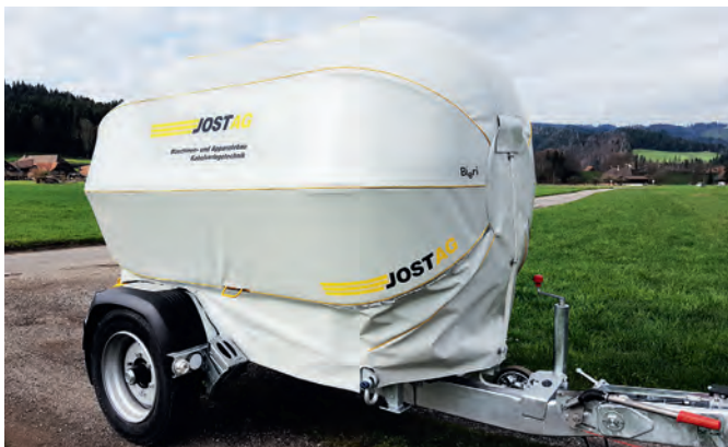
Structure bâchée pour protéger des intempéries et améliorer la sécurité
