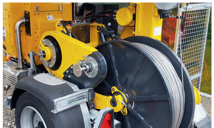
Assistance hydraulique pour le remplacement de bobine
