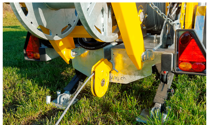
Entrée de câble centrale avec guide-câble rotatif
