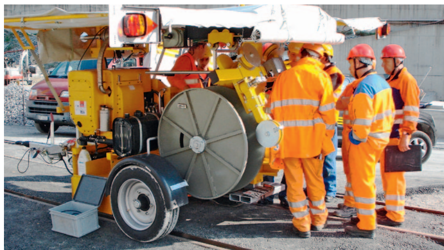
Les employés du client sont formés sur le treuil à cabestan KZM4
